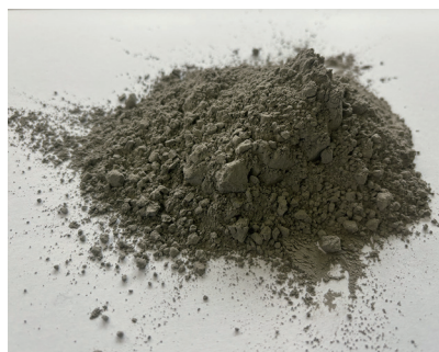
原料となるセメント 約5トン ※コンクリート1m 3 あたり300kg
